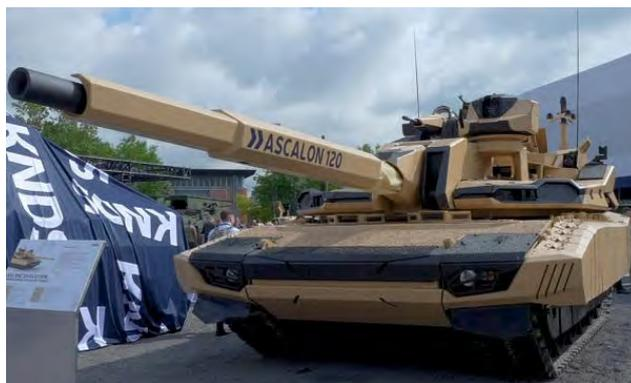
Pour rappel, KNDS France a soumis le système ASALON [Autoloaded and SCALable Outperforming guN], capable de tirer des obus de 120 et de 140 mm ainsi que des « munitions intelligentes pour des tirs au-delà de la vue directe » tandis que Rheinmetall défend son canon de 130 mm, lequel doit équiper la tourelle de son char KF-51 « Panther » qui, dévoilé en 2022, est en passe d'être retenu par l'armée italienne.
