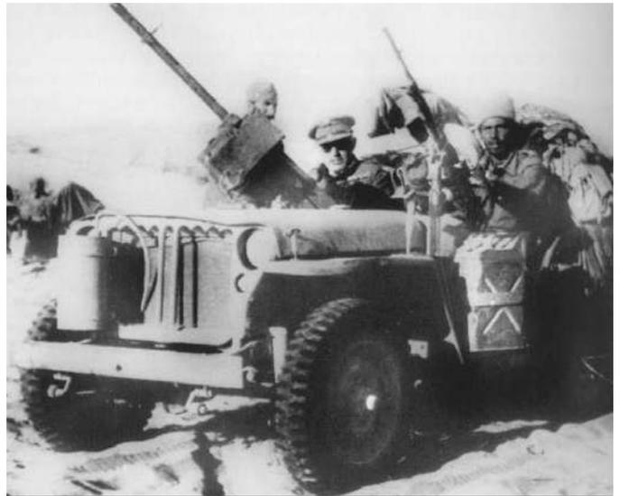
Jeep armée d'une mitrailleuse Vickers et d'une mitrailleuse Browning 12,7
